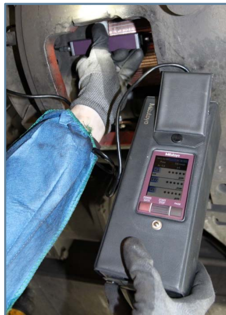
Mesure axiale avec le SJ210M dans son étui de transport
