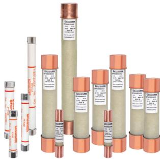
Les fusibles pour TP de Mersen sont limiteurs de courant avec un haut pouvoir de coupure conçus pour la protection au primaire des transformateurs de potentiel. Ils sont de petites dimensions, de type à férules pour installation dans des pinces standards. Les calibres disponibles sont de 0.25A à 10A.
